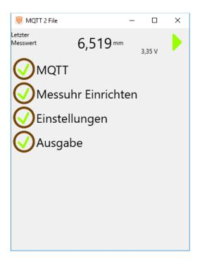
Wenn alle Punkte (Konfigurationsbereiche) "IO" sind und mit einem grünen Haken versehen sind wechselt die Software automatisch nach kurzer Zeit in den Messmodus.
