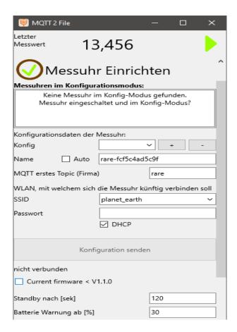
In der Liste werden alle WLAN SSIDs angezeigt, welche einem Modul zugeordnet werden können. Ist nur eine Konfiguration vorhanden wird diese automatisch gewählt.
